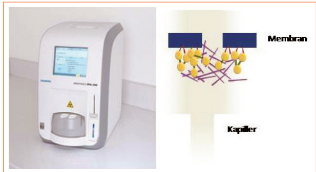
Şekil 3. "PFA-200" analizörü ve çalışma prensibi.
